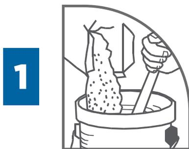
En 4 a 5 litros de agua agregue gradualmente un saco (20 kg) de **BASECOAT** Cemix y mezcle hasta obtener una pasta suave y libre de grumos. Espere de 10 a 15 minutos antes de usar la mezcla.
