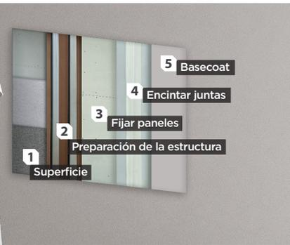
Producto a base de cemento, agregados y aditivos químicos que al mezclarse con agua forman una pasta que puede utilizarse como recubrimiento de paneles de fibrocemento, tabla roca y tabla yeso.
