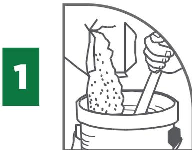
1 En 10,5 a 11,5 litros de agua agregue gradualmente un saco de 40 kg de Cemix Pulido y mezcle hasta obtener una pasta suave y libre de grumos. Espere 10 minutos antes de usar la mezcla. Sin agregar más agua vuelva a mezclar para usar.
