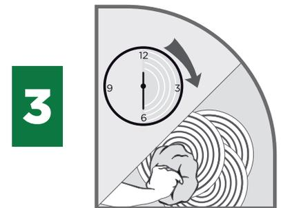
3 Aproximadamente 30 minutos después de la aplicación con una llana de duroport y con movimientos circulares dé el acabado floteado o el acabado deseado con llana metálica.
