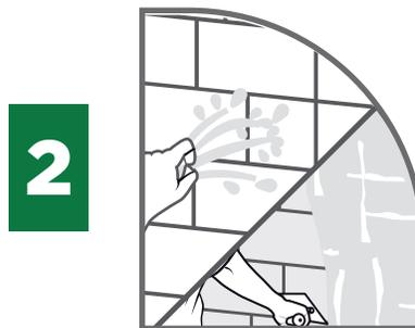
2 Humedecer la superficie donde se vaya a colocar la pasta de Cemix Pulido. Con una llana metálica cuadrada esparcir el material con movimientos hacia arriba y de izquierda a derecha formando una cruz.
