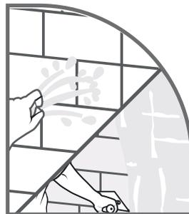
Humedecer la superficie donde se vaya a colocar la pasta de Cemix Repello Fino. Con una llana metálica cuadrada esparcir el material con movimientos hacia arriba y de izquierda a derecha formando una cruz.
