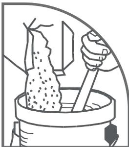
En 7.5 a 8.5 litros de agua agregue gradualmente un saco de 40 kg de Cemix Repello Blanco y mezcle hasta obtener una pasta suave y libre de grumos. Espere 10 minutos antes de usar la mezcla. Sin agregar más agua vuelva a mezclar para usar.
