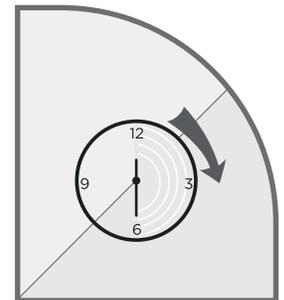
Cuando la mezcla aplicada en el muro este fraguada y con el nivel deseado deje secar por 24-48 horas antes de aplicar un acabado.
